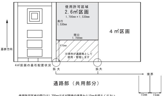
使用許可区域の間口は1,700mmですが隣接の境界から15mmを控えください。 よって巻石(間口)最大寸法は1,700mm-15mm-15mm=1,670mmとなります。 なお、巻石(奥行)の最大寸法は1,530mmです。
